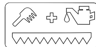
**Limpeza e manutenção da barra de corte.**
