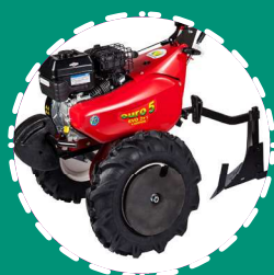
KIT LABOUR CLASSIC ruote 5.00-10" + assi fissi 2 zavorre ruote 20 kg cad. zavorra frontale 15 kg aratro classico
