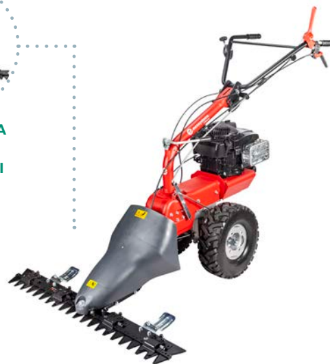
DOPPIA LAMA CON SLITTE REGISTRABILI
