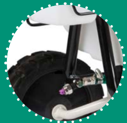
IRRORATORE ANTERIORE a ventaglio con due ugelli intercambiabili
